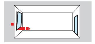
Per agevolare l'aerazione dei locali sono molto utili alcuni sistemi di aerazione automatizzati. Dei sensori misurano l'umidità dell'aria e la concentrazione di CO<sup>2</sup>. Elementi elettromeccanici di aerazione aprono e chiudono automaticamente le finestre a seconda delle esigenze. Questi elementi automatici possono essere ordinati direttamente presso il costruttore prima dell'installazione del nuovo serramento, oppure venire installati in un secondo momento su serramenti già installati.
