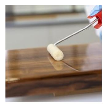
Tuttavia, con Legno Dura-Öl si raccomanda un'applicazione sottile e uniforme a rullo o a pennello. Per Legno Aqua-Öl, applicare l'olio a pennello. Se necessario, l'applicazione può essere ripetuta dopo 5 ore.
