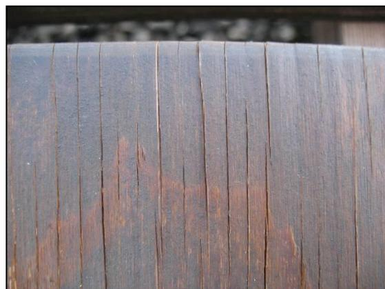
fig. 2.3: Formazione di screpolature
