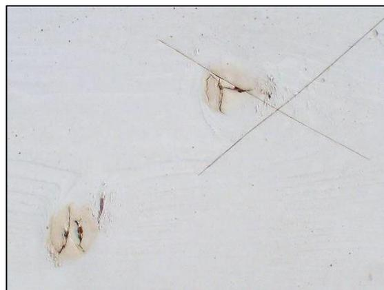
Fig. 2.7: Viraggio di colore del sistema verniciante causato da sostanze interne nel legno nella zona dei nodi
