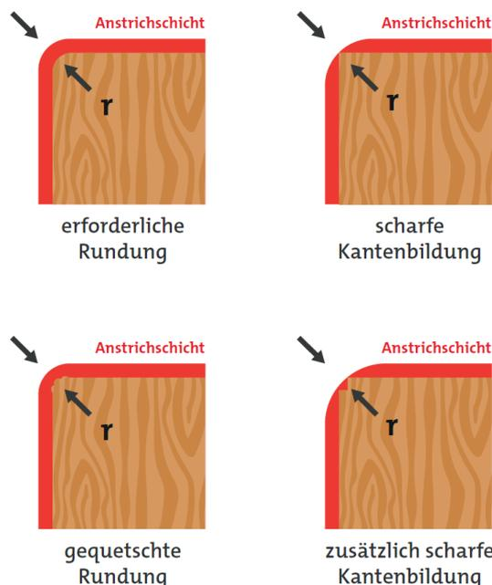
Fig. 4.1: Arrotondamento degli spigoli
