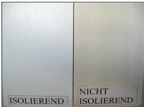
Fig. 2.6: Confronto dell'effetto isolante di un ciclo di verniciatura con e senza riempitivo isolante
