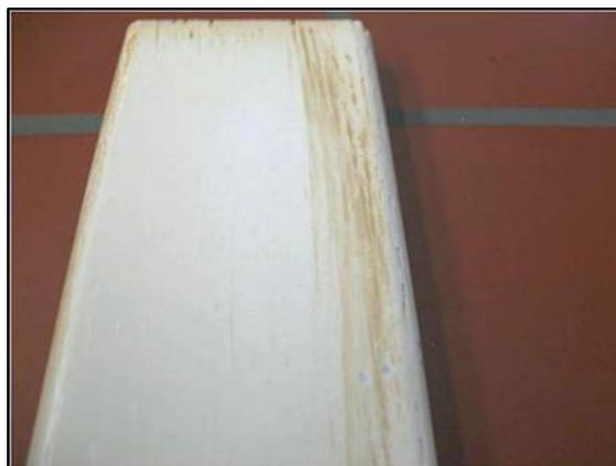
Fig. 2.5: Viraggio di colore del sistema verniciante causato da sostanze interne nel legno
