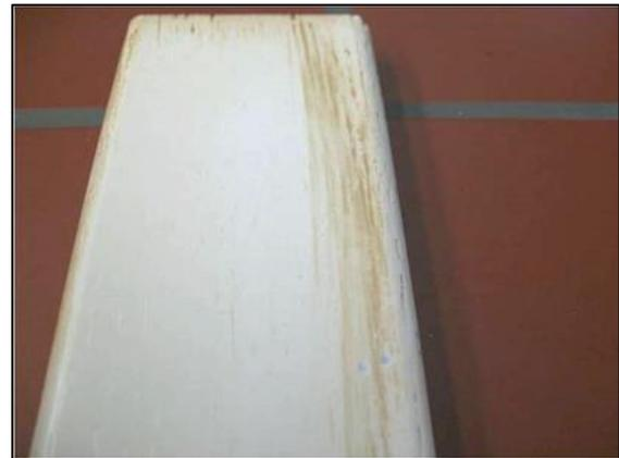
Fig. 2.6: Viraggio di colore del sistema verniciante causato da sostanze interne nel legno
