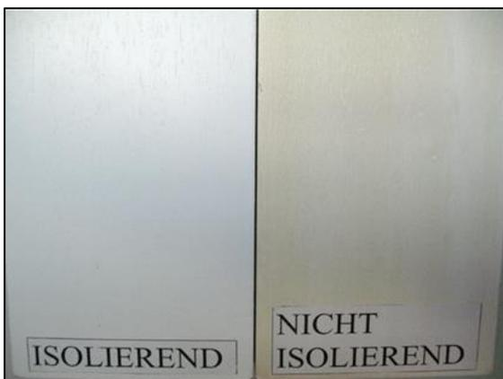
Fig. 2.5: Confronto dell'effetto isolante di un ciclo di verniciatura con e senza riempitivo isolante
